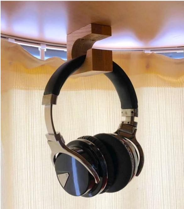
Deux morceaux de chêne de ¾" laminés en croisé et ai utilisé une scie circulaire pour percer le trou principal, puis une scie à ruban pour couper la fente d'accès.
