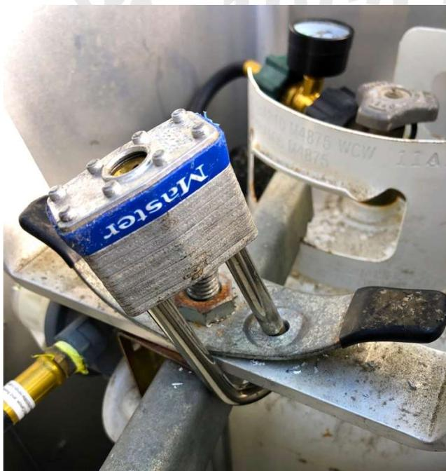
J'ai percé un trou de 3/8" à travers la sangle de fixation et l'écrou à oreilles de verrouillage pour fournir un dispositif de protection contre le vol sécurisé et relativement difficile à contourner.
